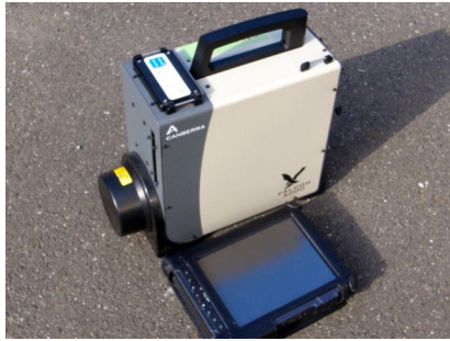
携帯型ゲルマニウム半導体検出装置 FALCON 5000 (Canberra 社製)
